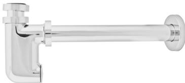
**CARATTERISTICHE:** MADE IN ITALY, sifone a bottiglia, adatto a tutti i sanitari, ottone cromato da 1 1/4", tubo interno Ø 32 mm lunghezza 80 mm, tubo esterno Ø 33 mm lunghezza 252 mm, rosone ottone Ø 70 mm, garanzia sul prodotto di 5 anni, imballo singolo in scatola cartone.
