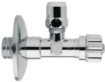
**CARATTERISTICHE:** MADE IN ITALY, rubinetto sottolavabo, connessione 1/2" M x Ø 10, vitone 14 x 1 M asta fissa, maniglia in ABS cromato, dado compressione basso, garanzia sul prodotto di 5 anni, imballo singolo in scatolina cartone.
