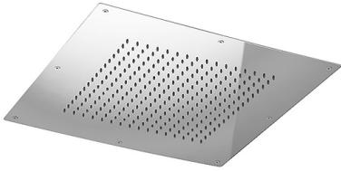
Soffione doccia in acciaio inox 304 L, 1 getto fisso anticalcare, serie **EDITH** dal design moderno, di forma quadra 500 x 500 mm, spessore 2 mm. Dotato di tappetino di gomma con 256 ugelli anticalcare di forma conica e facili da pulire. Sistema di incasso a telaio di sostegno con cavi di sicurezza in acciaio inox da ancorare al soffitto. Connessione ½" M.
