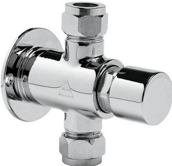
**CARATTERISTICHE:** MADE IN ITALY, design classico, rubinetto a pulsante, pressione di alimentazione min 1 max 6 bar, pressione raccomandata 2 - 4 bar, temperatura di alimentazione 5 - 65°C, tempo di erogazione: 15 +/- 5 sec. a 3 bar, garanzia sul prodotto 5 anni, imballo singolo in scatola.
