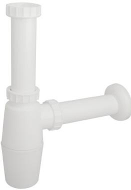
**CARATTERISTICHE:** MADE IN ITALY, sifone a bottiglia per lavello, polipropilene bianco, attacco 1 1/2", tubo entrata Ø 32 allargato a Ø 40 x 120 mm, tubo scarico Ø 40 x 250 mm, rosone polipropilene bianco, garanzia sul prodotto 5 anni, imballo singolo in sacchetto plastica.
