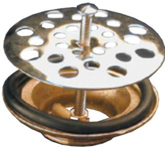
**CARATTERISTICHE:** MADE IN ITALY, piletta simplex per doccia in ottone nichelato, connessione 1.1/4", griglia perforata in acciaio inox Ø 85 mm, vite inox modello export Ø 6 x 60 mm, guarnizioni di tenuta in gomma, garanzia sul prodotto di 5 anni, imballo singolo in sacchetto plastica.
