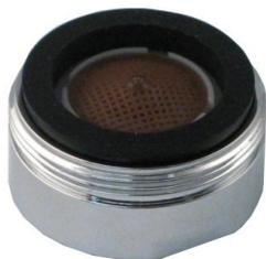
**CARATTERISTICHE**: MADE IN ITALY, aeratore costante di portata acqua, corpo in ottone cromato, connessione da 24 x 1 M, aeratore in POM, rete superiore speciale, rete inferiore speciale per la rimozione del calcare, portata costante di 6 lt/min, guarnizione in gomma, garanzia sul prodotto di 5 anni, imballo scatola cartone da 10 pezzi.
